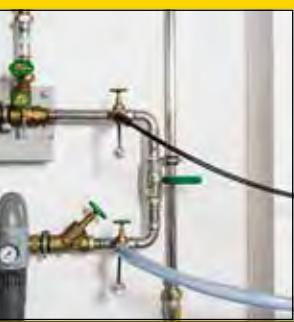
Δοκιμή πίεσης με πεπιεσμένο αέρα
